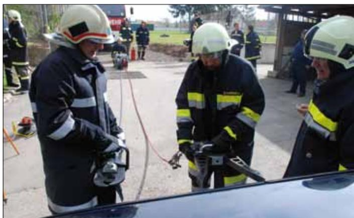
Die Feuerwehrmänner mit der hydraulischen Rettungsschere und dem hydraulischen Rettungsspreizer.
